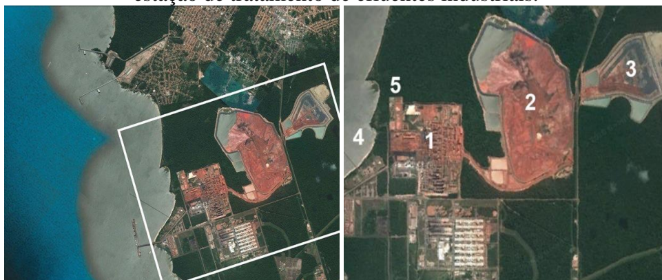
Figura 2.11 - Vista de satélite da Alunorte e do rio Pará (1) área da refinaria, (2) depósito de RB 1, (3) depósito de RB 2, (4) descarte de água licenciado para Rio Pará e (5) estação de tratamento de efluentes industriais.
