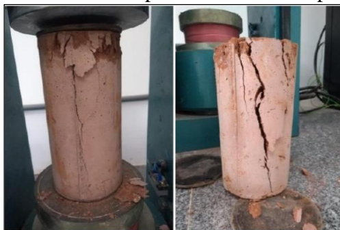
Figura 2.20 – Ensaio de compressão uniaxial e após o rompimento.
