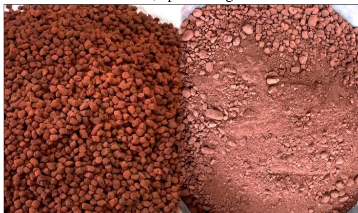
Figura 3.13 – Antes do ensaio, após o desgaste à Abrasão do ASRB-90.
