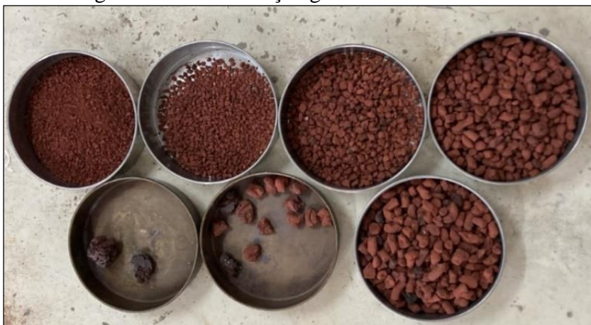
Figura 3.8 – Distribuição granulométrica ASRB-90.
