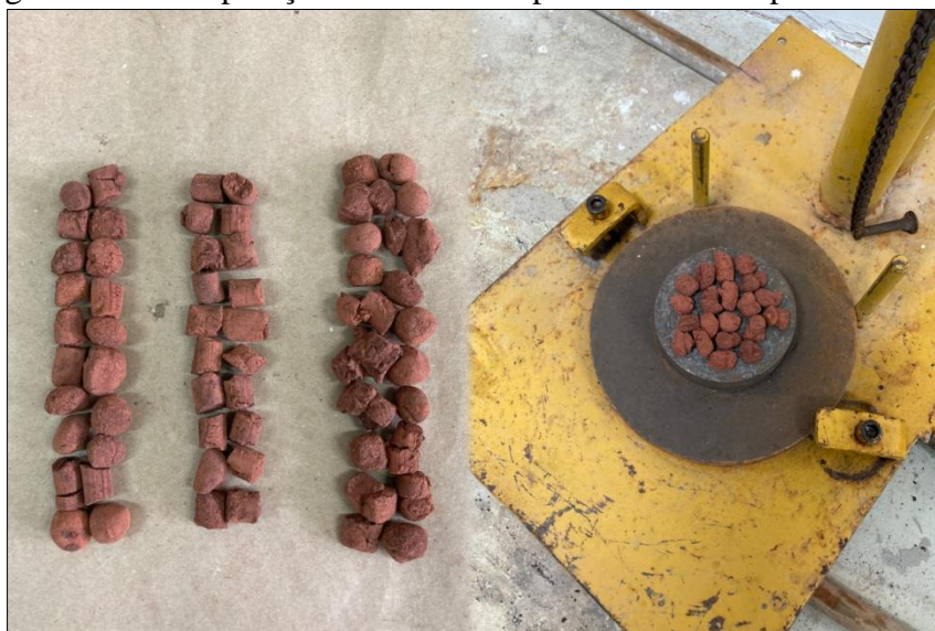
Figura 3.15 – Preparação do ASRB-80 para o ensaio de perda ao choque.
