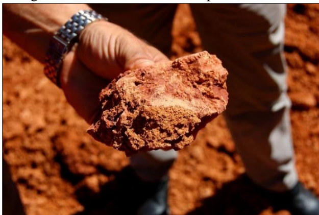
Figura 2.10 – Bauxita: matéria-prima do alumínio.
