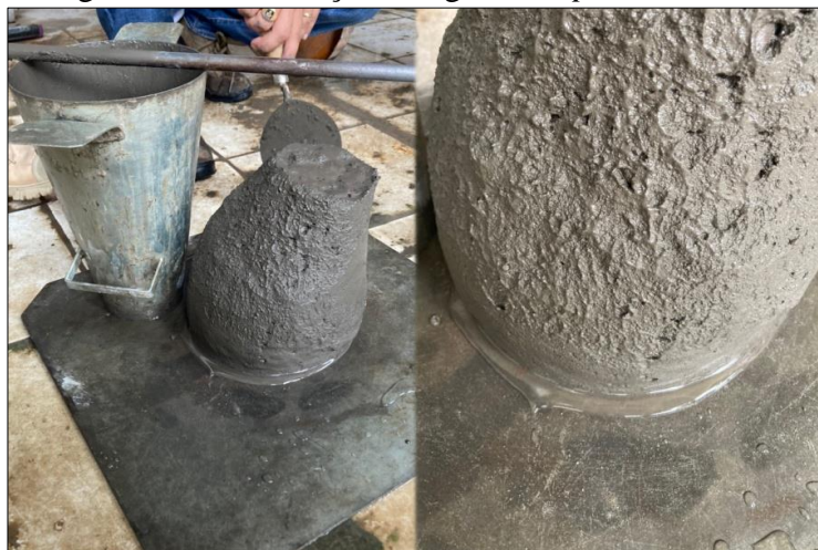
Figura 4.8 - Exsudação de água Slump Test ASRB-90.
