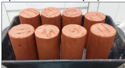
Figura 2.19 – Corpos de Prova com composições de 30% e 50% de RB.
