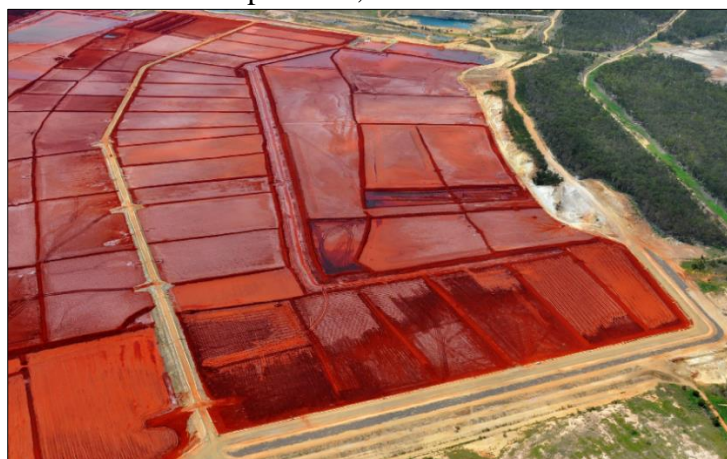
Figura 2.12 - Instalações de armazenamento de resíduos de bauxita dividido em baías, onde é depositado, cultivado e secado.
