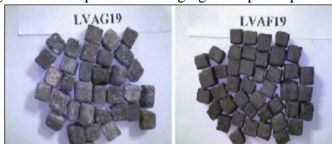
Figura 2.16 – Aparência dos agregados após a queima.
