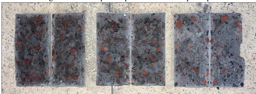
Figura 4.10 – Corpos-de-provas ASRB-70 após ruptura.
