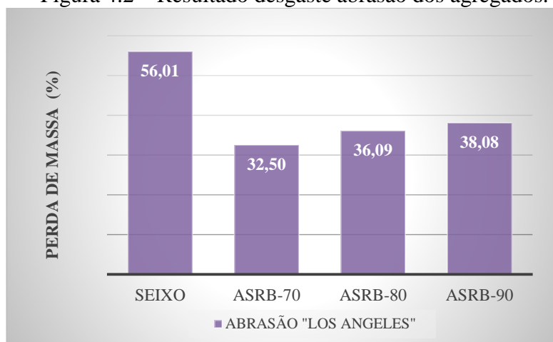
Figura 4.2 – Resultado desgaste abrasão dos agregados.
